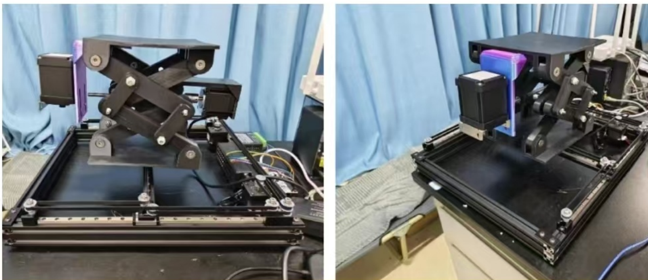
新能源汽车无线充电桩 湖南工业大学
