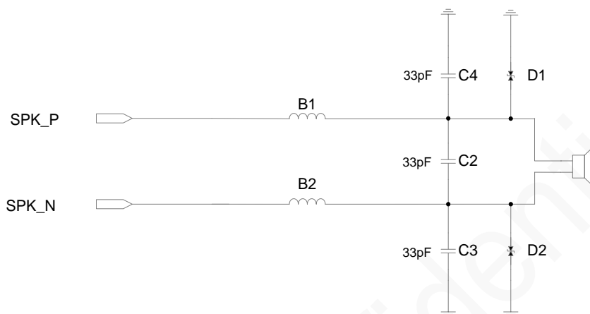
图 5-29 内置功率放大器参考设计
